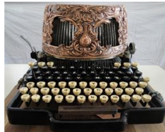
Barlock 6 Volltastaturmaschine mit Oberaufschlag ab 1896
