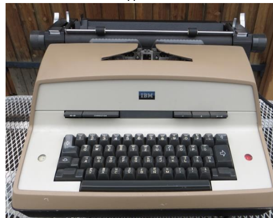
Die elektrische IBM Modell D. Spezialanfertigung als Blindenschreibmaschine mit Braille Schrift.
